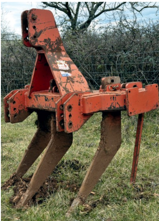
Este subsolador con 3 rejonés está rompiendo el suelo a una profundidad de 40 cm
