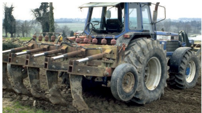
Subsolador con marco recto y dientes inclinados (F. Gallois - CNPF)
