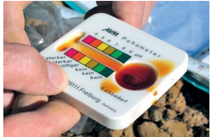
En el campo, la acidez del suelo se mide con un pH-metro colorimétrico. Si el suelo es demasiado ácido, será más difícil para los árboles capturar los minerales. Un alto valor de pH generalmente indica la presencia de contenido de piedra caliza activa
