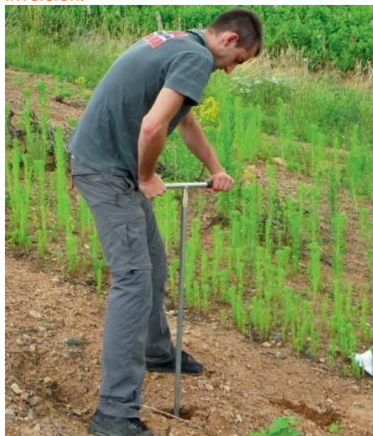
Uso de sonda de suelo para recoger muestras de tierra como parte de la evaluación ambiental agroforestal (Ph. Gaudry - CNPF)
