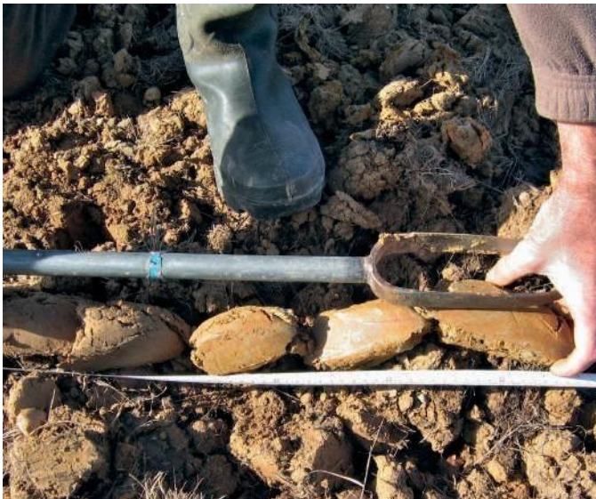
Las muestras del suelo se recogen mediante una sonda desde la superficie hacia abajo. El suelo entero se reconstituye yuxtaponiendo las sucesivas muestras del suelo
